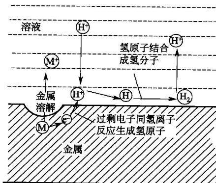
图 0-9 金属腐蚀原理
