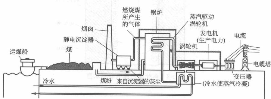
图 0-6 火力发电站工作流程
