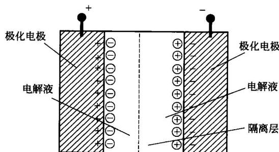
图 0-8 电化学超级电容器示意
