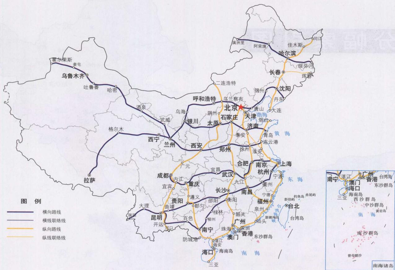
“五纵七横”国道主干线规划于1992年，由交通部正式提出，总长约3.5万千米。“五纵”是指5条南北走向国道主干线，“七横”是指7条东西走向国道主干线，主要路线都采用高速公路技术标准。在我国构筑起第一个以高速公路为主体的“全国公路主骨架系统”。
