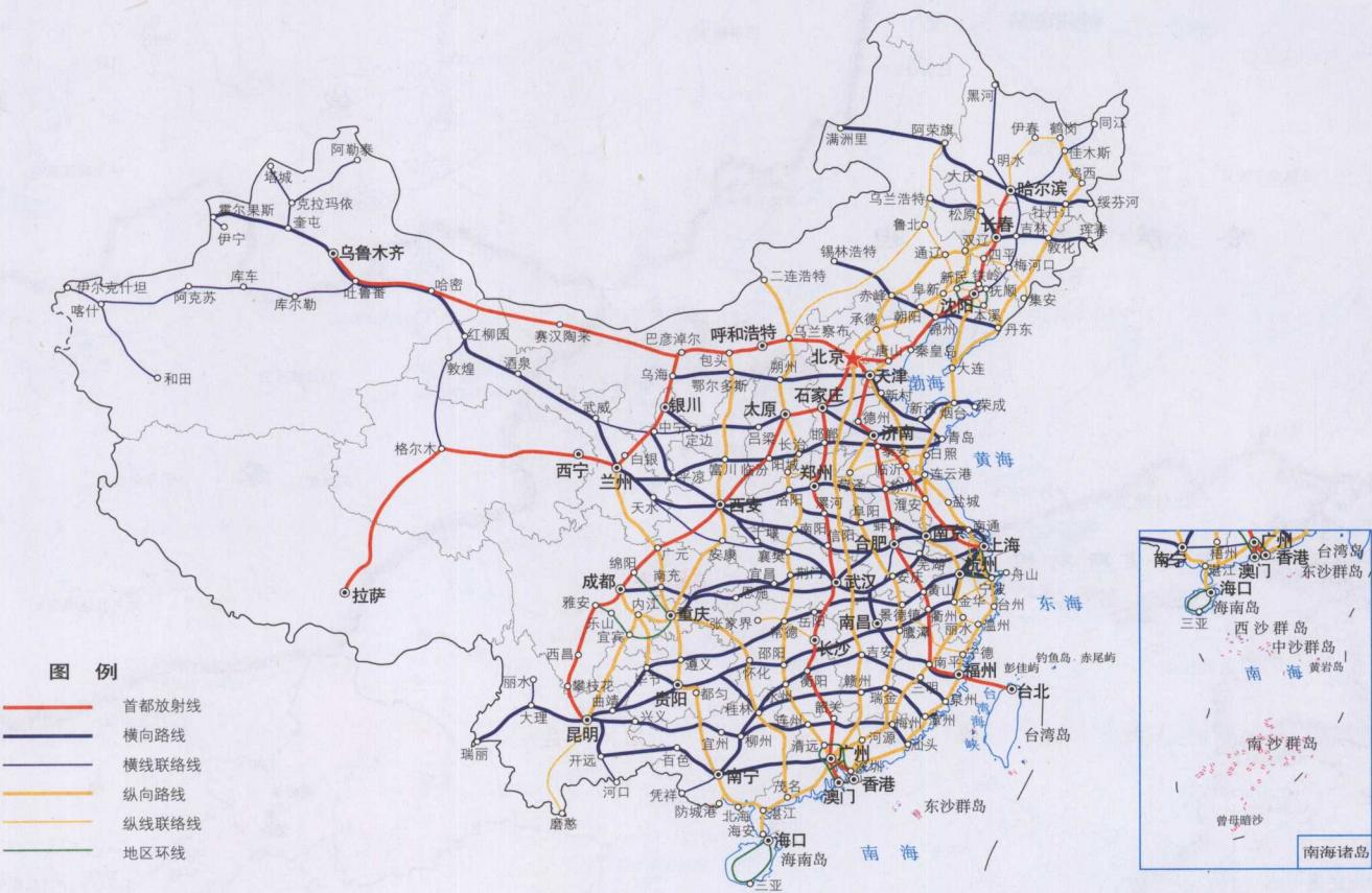
国家高速公路网（简称“7918”网）规划于2001年，计划30年内建成，采用放射线和纵横网格相结合的形式，包括7条首都放射线、9条纵向路线和18条横向路线，此外，还有6条地区环线、18条城市环线、30条联络线。总规模约8.5万千米，其中主线6.8万千米，地区环线、联络线等其他路线约1.7万千米。
