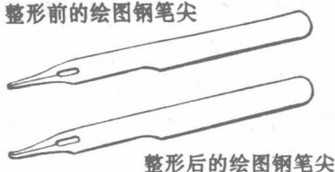
图 1-5 整形前、后的绘图钢笔尖
