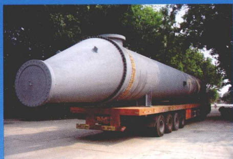
炼油装置用大型换热器
