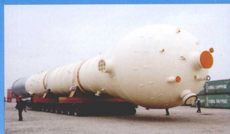
直径7米、重达400吨美国DOW工艺 聚丙烯气相反应器
