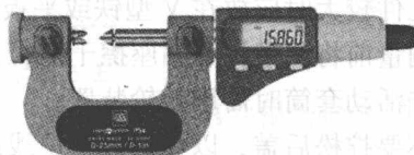
图 1-22 数显螺纹千分尺
