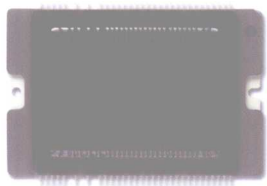
▲ 上图 数码单反相机的CCD影像传感器。影像区域仅为1英寸×2/3英寸(2.54cm×1.67cm),却含有630万个感光点,即630万像素。
