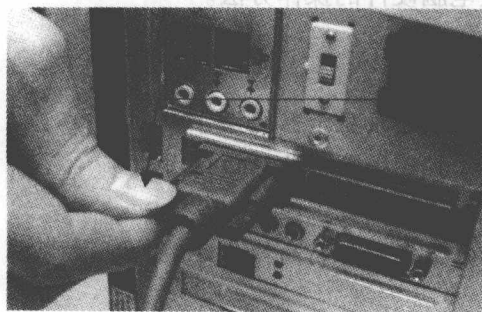
图 1-2 D-Sub 接口连接到显卡的视频输出接口
