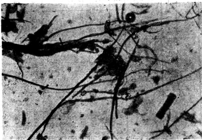
图5 稻草經打浆机打浆并經精浆机精浆后的纖維形态 ( \times 85 ) 漿號: 1-190 叩解度29°SR
