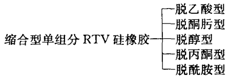
图 1-2 缩合型单组分 RTV 硅橡胶的交联体系类型
