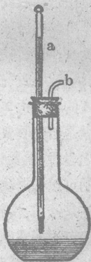
圖 2. 測定液體沸點的裝置
