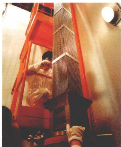
▲ 燃料组件外观检查
