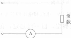
图 1-5 测量直流电流
