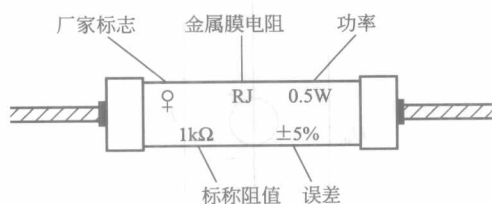
图 1-21 电阻器参数直标法
