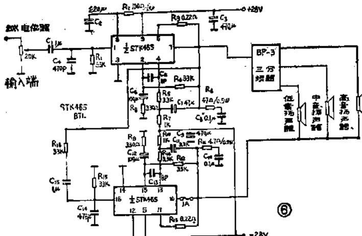
电路原理如图6所示。电路中 $C_1$ 、 $C_{15}$ 是输入耦合电容器，最好使用无极性电容器，如果使用电解电容器负端应接集成电路的1脚和6脚。 $C_4$ 、 $C_{14}$ 是高频旁路电容，用以将高频信号短路以防自激。 $R_3$ 、 $R_{13}$ 是限流电阻。可以用万用表量一段电阻丝，然后绕在其它电阻上代替。
