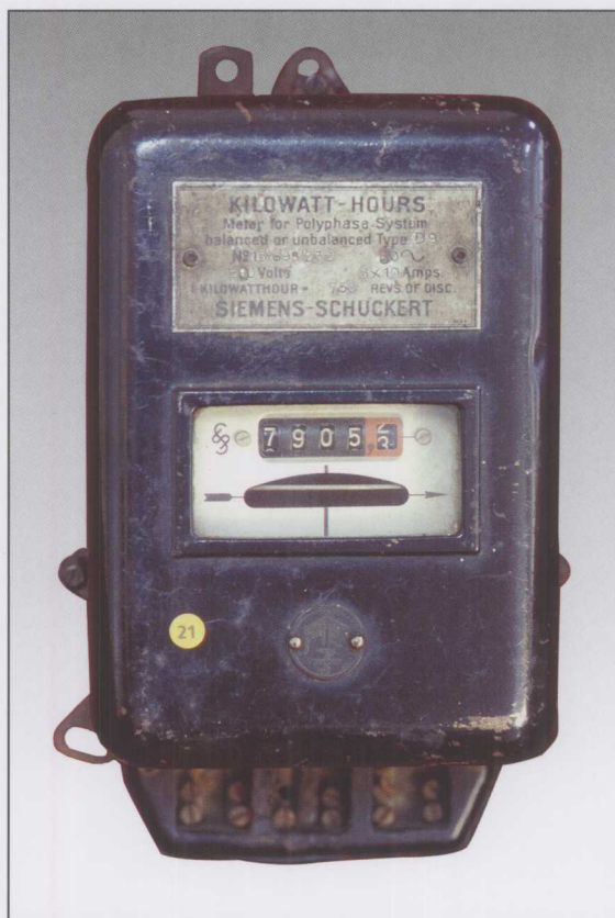
名称:三相四线有功电能表 型号: D9 型 参数: 200V , 3 \times 10A , 750 Rev/kWh, 60Hz 制造厂名称:德国西门子公司 制造年份:1940 年 适用范围:厂矿工业用电计量
