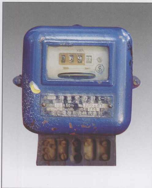
名称:交流单相二线式电能表 型号:E—2 型 参数:100V,10A,2000 Rev/kWh,50Hz 制造厂名称:日本富士电机制造株式会社 制造年份:昭和 16 年(1941 年) 适用范围:居民生活用电计量
