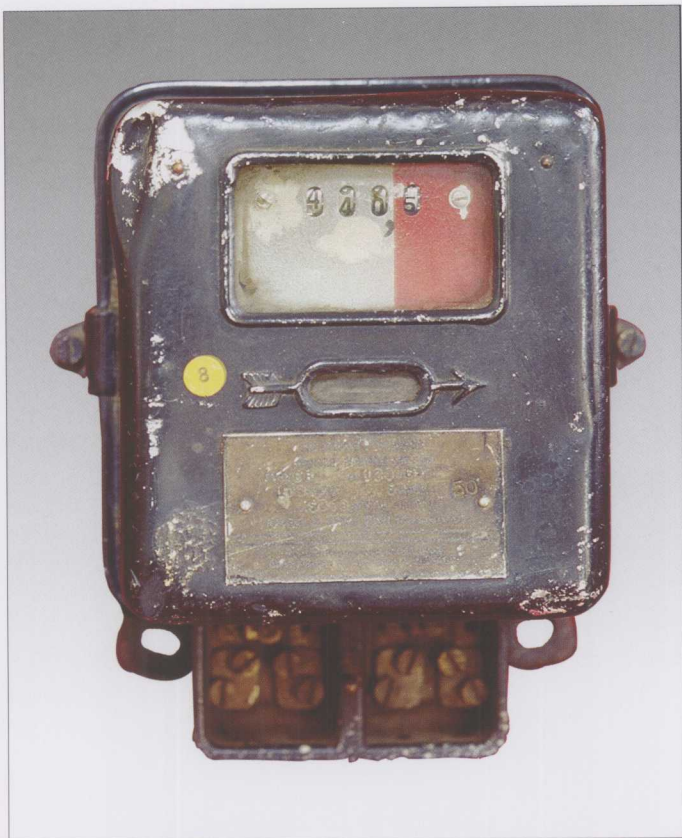
名称:单相电能表 型号: C8 型 参数:100V, 5A, 50Hz, 5000r/kWh 制造厂名称:瑞士 LANDIS GYR 公司 制造年份:1930 年 适用范围:居民生活用电计量
