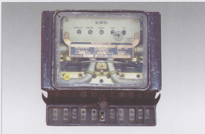
名称:交流三相四线有功电能表 型号: FLX 型 参数: 3 \times 380/220V , 3 \times 50A , 15 Rev/kWh, 50Hz 制造厂名称:英国 FRT 公司 制造年份:1940 年 适用范围:厂矿工业用电计量
