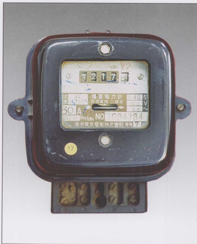
名称:单相电能表 型号:1—4G 型 参数: 200V, 30A, 50Hz, 833 - 1/3\text{Rev/kWh} 制造厂名称:日本满洲东京电气株式会社 制造年份:康德 7 年(1940 年) 适用范围:居民生活用电计量
