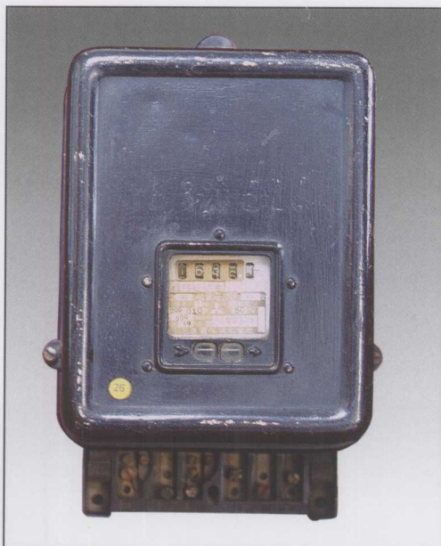
名称:交流三相三线有功电能表 型号:MY 型 参数:200V,10A,500 Rev/kWh,50Hz 制造厂名称:日本三菱电机株式会社 制造年份:昭和 17 年(1942 年) 适用范围:厂矿工业用电计量
