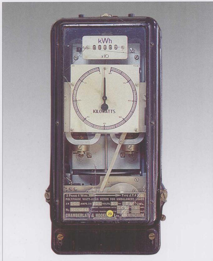
名称:三相四线电能表 型号: JT4 型 参数: 3 \times 220V , 3 \times 100A , 25 Rev/kWh, 50Hz 制造厂名称:英国 CH 公司 制造年份:1940 年 适用范围:厂矿工业用电计量
