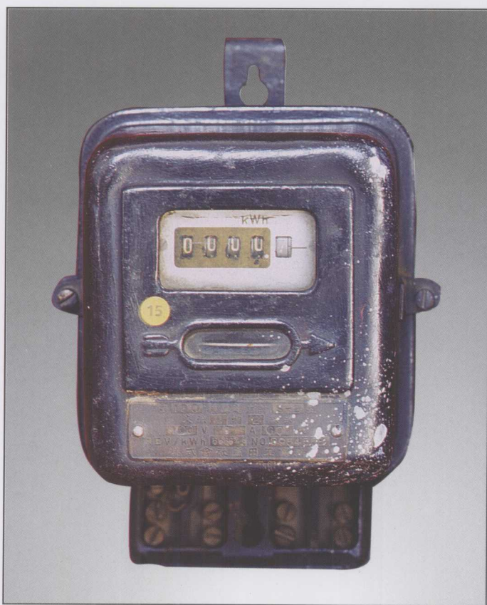
名称:交流单相二线式电能表 型号:S—2 型 参数:100V,3A,6666-2/3 Rev/kWh,60Hz 制造厂名称:日本株式会社芦田工业所 制造年份:1940 年 适用范围:居民生活用电计量
