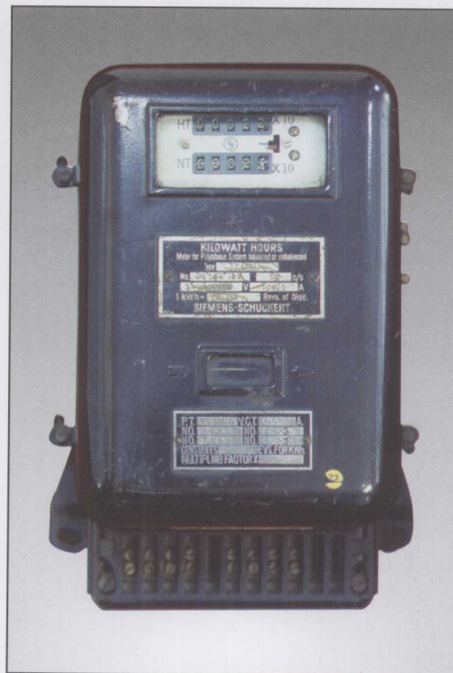
名称:三相四线电能表 型号:ZD7 型 参数: 110V, 5A 制造厂名称:西德西门子公司 制造年份:1940 年 适用范围:厂矿工业用电计量
