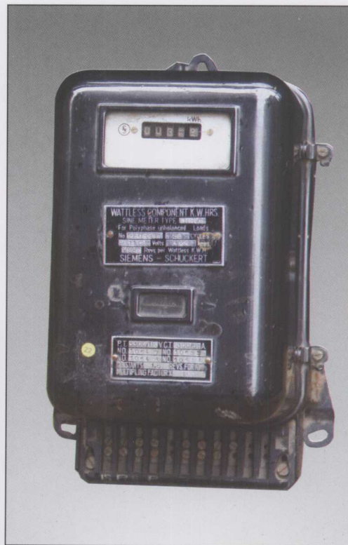
名称:三相四线有功电能表 型号:ZD7 型 参数: 3 \times 110V, 3 \times 5A 制造厂名称:西德西门子公司 制造年份:1940 年 适用范围:厂矿工业用电计量
