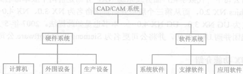
图 1-1 CAD/CAM 系统组成
