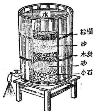
圖六 家庭濾水器橫斷面 表示內部材料的充填法
