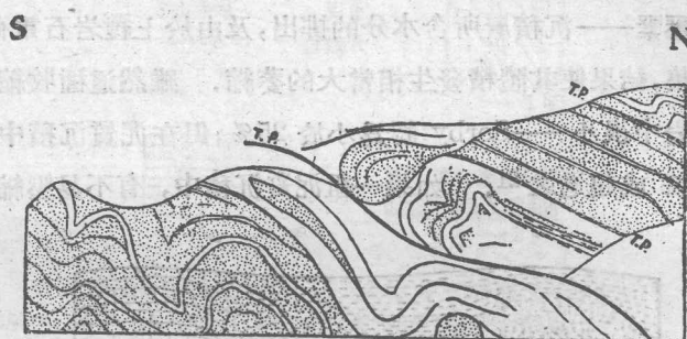
圖7 阿爾博特泥崗上白堊系泥、砂層受冰擾亂的情形。
