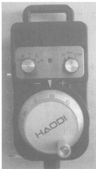
图 1-3 MPG 手持单元结构
