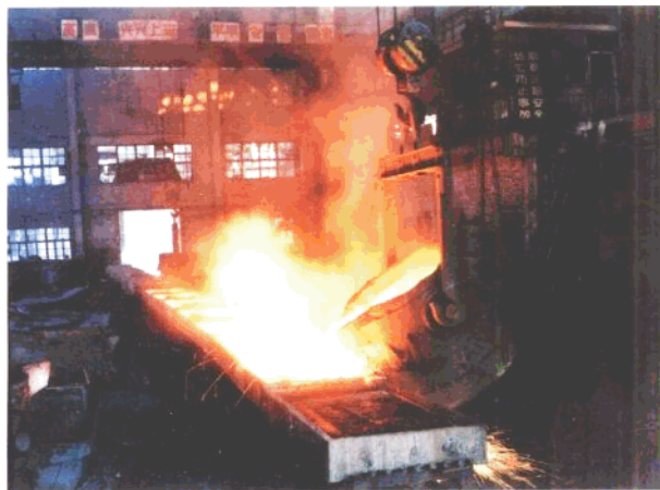
山川铁合金 厂正在进行硅铁 浇铸
