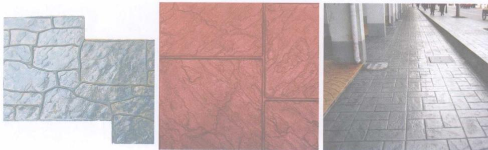
装饰混凝土是在普通混凝土的基础上逐渐发展起来的一种饰面混凝土，即充分利用混凝土的塑性成型及材料构成特点，在构件成型时，采取一定的施工工艺，使其表面具有装饰性的线性、纹理质感，并改善其色彩效果，在某些程度上满足装饰设计的要求。因此，装饰混凝土又称为“建筑艺术混凝土”或“视觉混凝土”。
