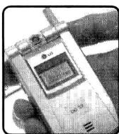
LG G8000 是一款双屏翻盖手机，它支持 GPRS Class 10, WAP 2.0。它在手机转轴中央内置了一个可以旋转 270 度的 CMOS 摄像头，无论是拍照或者自拍，只要任意旋转相机镜头，影像就能在彩色屏幕上显现。不仅如此，G8000 还可以拍摄 5 段（每段 20 秒）分辨率高达  $352 \times 288$  像素的 CIF 格式动态视频，同时内置的多媒体播放器搭配图形编辑功能，可以方便地管理使用者拍摄的照片。
