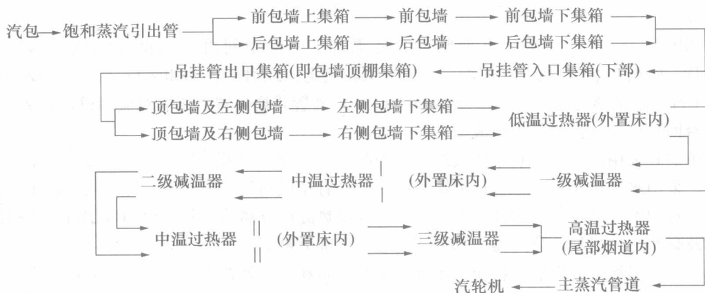
图 1-2 300MW 循环流化床锅炉过热蒸汽流程
