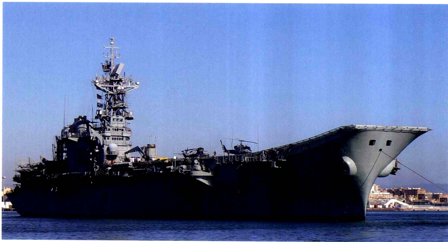
↑ 图为西班牙航母“阿斯图里亚斯王子”号（Príncipe de Asturias）。系西班牙首艘国产航母，其设计以美国曾一度计划建造的制海舰为基础。舰首滑跳式甲板坡度为12度，长度为46.5米，于1988年开始服役，满载排水量17,188吨。
