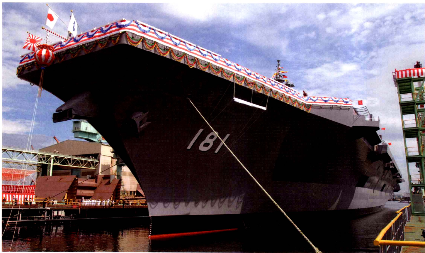
↑↓图为直升机护卫舰“日向”号（Hyuga）下水当天情景，2007年8月23日摄于日本石川岛播磨重工的横滨工厂。上图为船坞刚刚下水情景，下图为该舰下水后朝向码头一侧的船体。该舰体型大小与前面介绍的“阿斯图里亚斯王子”号相当，但由于舰载机只有直升机因此不具备滑跳式甲板。该舰于2009年服役，满载排水量18,000吨。
