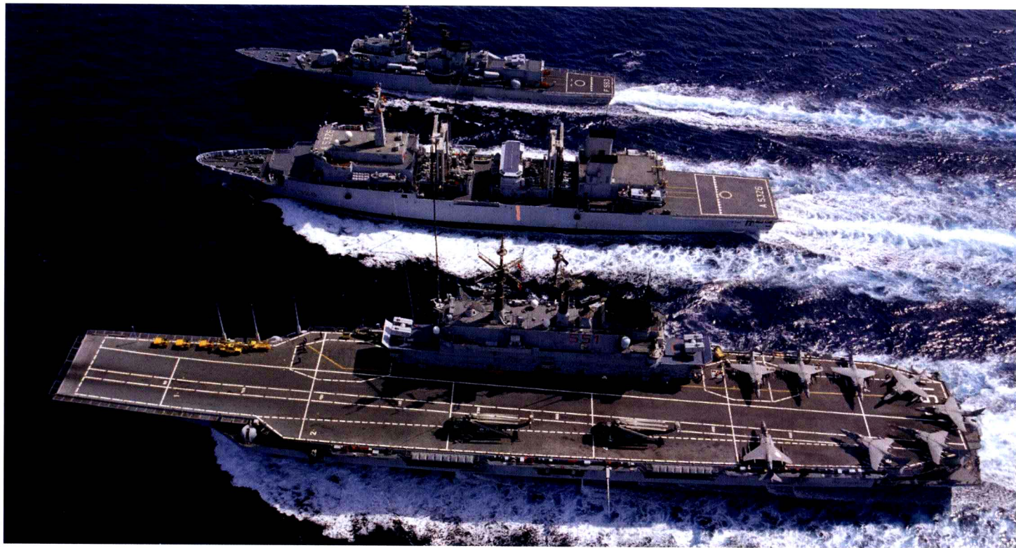
↑ 图为航行中的意大利航母“朱塞佩·加里波第”号（Giuseppe Garibaldi）。它系1985年服役的意大利首艘航母，其满载排水量虽仅为13,850吨，却拥有世界轻型航母中最像航母的外观。其飞行甲板上停放着“鹞”II式V/STOL战斗机和海王式直升机。
