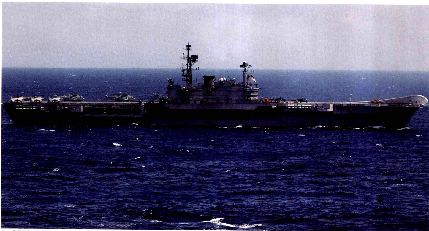
↓ 图为印度航母“维拉特”号（Viraat）在2007年9月的“马拉巴2007”军演时的情景。该舰前身为1959年服役的英国“竞技神”号（Hermes），它与前页介绍的“无敌”号一起参加了1982年的福克兰岛战争（也称“马岛战争”）。舰首的滑跳式甲板保留了英国海军的原设计。其满载排水量28,700吨。
