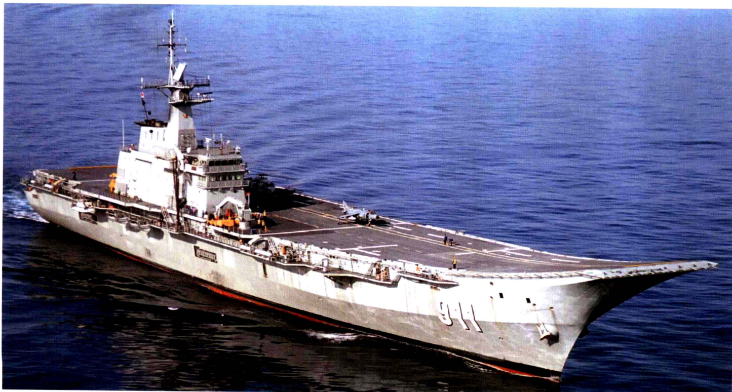
↓ 图为泰国航母“差克里·纳吕贝特”号（Chakri Naruebet）。该舰为泰国建国以来首艘航母，是以前述的“阿斯图里亚斯王子”号为基础设计并在西班牙建成的。于1977年开始服役。满载排水量11,485吨，为世界最小型航母。与“阿斯图里亚斯王子”相比，由于飞行甲板需加长必要长度，因此其滑跳式甲板前段显得极为前突。
