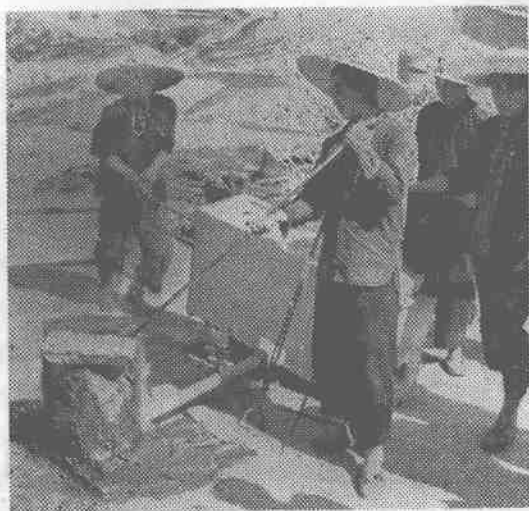
煉銅的方法很簡單，爐內第一層裝煤二十斤，煤上加銅砂子二十斤，拉動風箱，用火燒煉半小時左右，銅水即漏到爐子下面。
