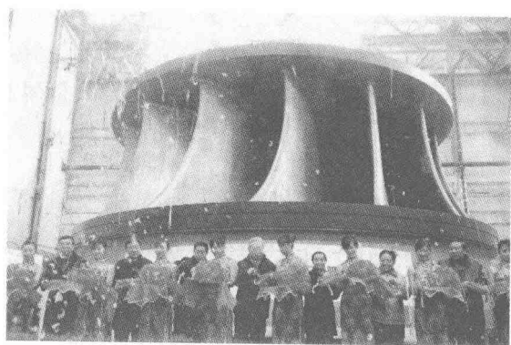
图 1.2 三峡工程用水轮机叶轮
