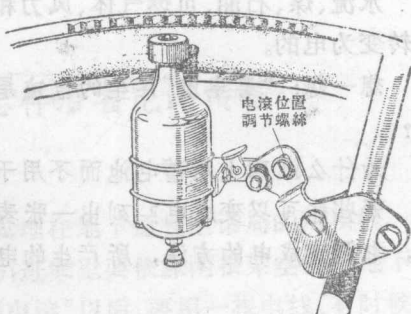
图 10 自行车车轮带动的发电机——“磨电滚”
