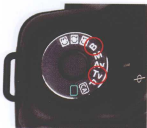
如图所示为 Canon 5D II 机顶拍摄转盘。B 表示 Bulb 快门，Tv 则代表快门优先模式。
