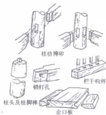
图1-2 河姆渡遗址木构件榫卯图
