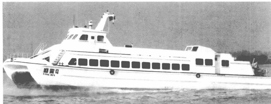
◀ 黄埔造船厂1992年建造的162客位铝质气垫船
