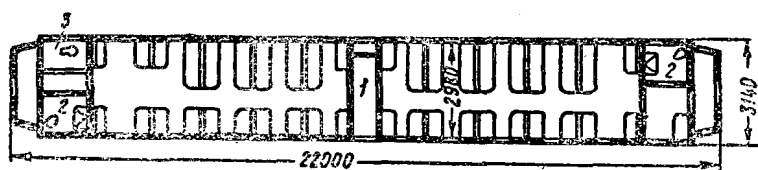
圖456. 有三个通过台的22公尺四軸市郊車輛之平面佈置圖
