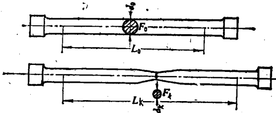
图 1—1 钢的标准拉伸试样及拉断后的试样
