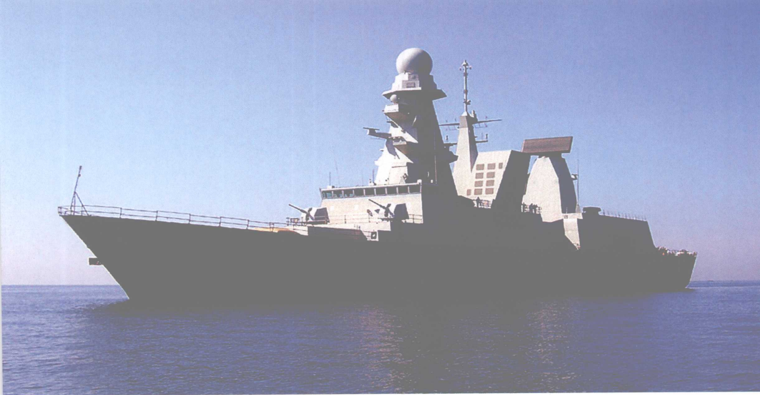
↓ 东福尔郡号护卫舰（挪威）图为在西班牙建造的弗里德约夫·南森级护卫舰，2007年4月开始投入使用。它虽然配备了宙斯盾舰的系统，但是因为对空导弹的扩展性为C，SPY-1相控阵雷达也是数列少的类型（有效射程短），所以它防空能力受到一定限制，该舰满载排水量为5290吨。
