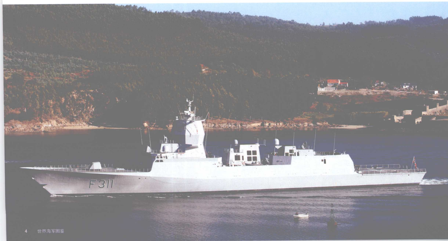
↑ 安德里亚·德利亚号导弹驱逐舰（意大利）图为意大利和法国共同研制开发的水平线型导弹驱逐舰，于2007年12月开始服役。以防空系统为主要功能的雷达是意大利的EMPER公司制造的，它装备在塔形桅杆顶端的球形顶内，该舰满载排水量为6635吨。
