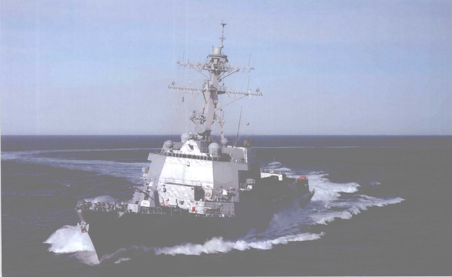
↑ 桑普森号导弹驱逐舰 DDG-102（美国） 图为埃雷博克级导弹驱逐舰，于2007年11月开始服役。它配有电子战装置和直升飞机的搭载设施，满载排水量为9115吨。
