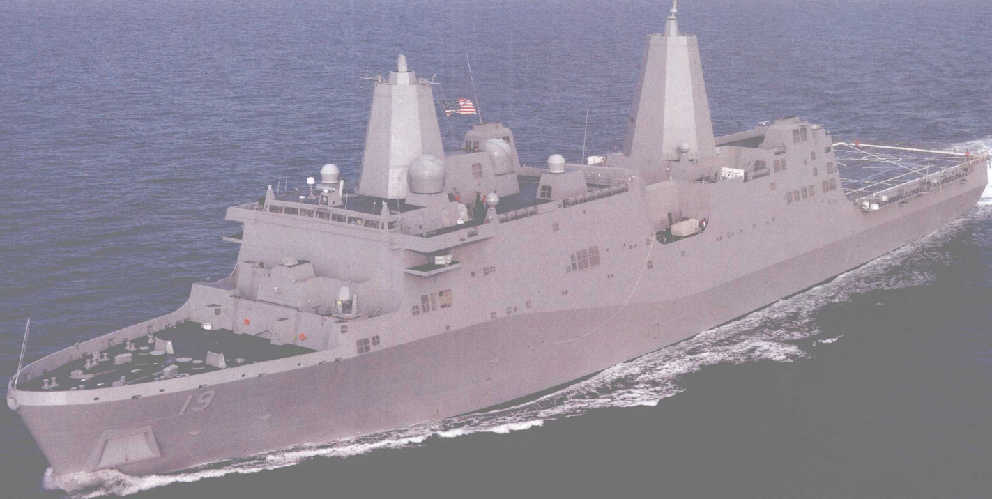
↑ 佛得角山号船坞型登陆舰（美）该舰属圣安东尼奥级，2007年12月投入使用。这个等级的登陆舰隐形技术高是其一个特征，设计在船身前后的塔形桅杆具有只能透过自身发出的电波、反射其他雷达波的构造，该舰满载排水量25885吨。
