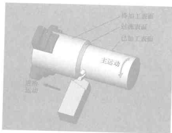
图 1-1 外圆车削运动和加工表面
