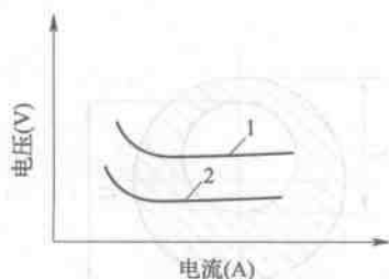
图 1—1—3 电弧静特性曲线随长度的变化
