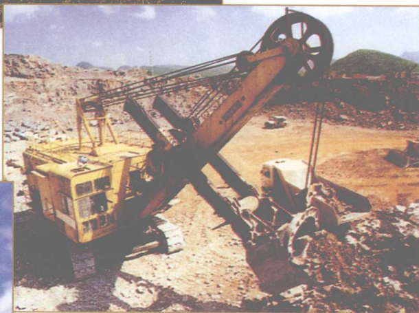
修文铝矿露天采场机械化作业
