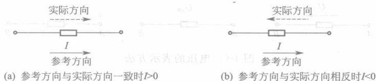
图 1-3 电流的参考方向与实际方向
