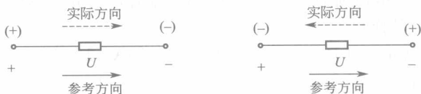
(a) 参考正方向与实际方向一致时 U > 0 (b) 参考正方向与实际方向相反时 U < 0
