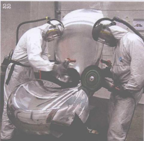
17~19. 从模具中分离铸造完成的部件，经过修整然后焊接到一起。图中所示的就是四个部件焊接到一起的效果（参见图 19）。
