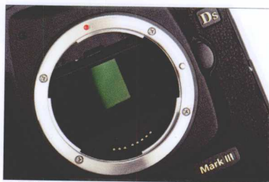
▲EOS-1Ds Mark III备有一个2110万像素的全幅CMOS传感器。
