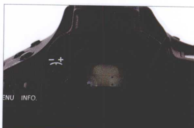
▲EOS-1Ds Mark III设有Eye-piece Shutter，能阻止光线从取景器进入，对细小光圈的长时间曝光拍摄尤其重要。
