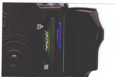
▲机身上的CF卡（支持高速的UDMA技术）及SDHC卡双插槽。
