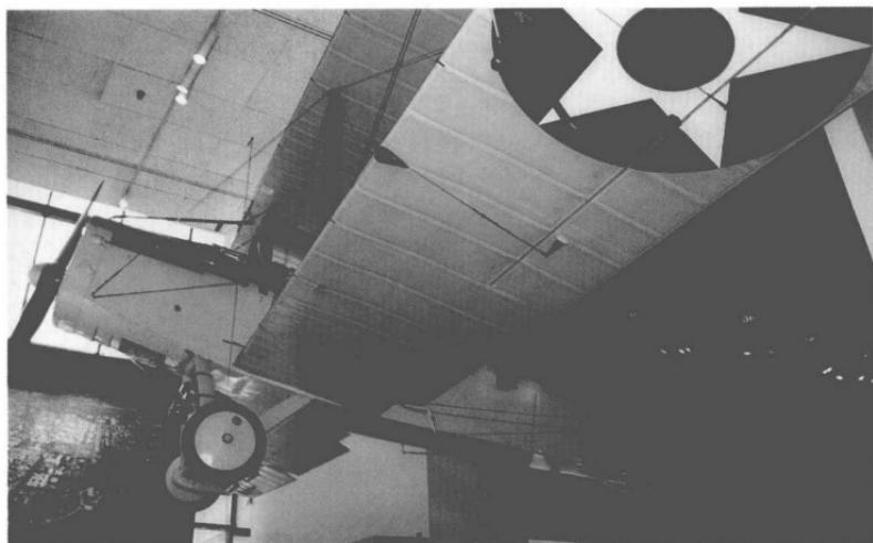
DH 4 是飞机制造公司 (Aircraft manufacturing Company, Airco, 后来的德·哈维兰) 应英国航空部于 1916 年初提出的要求而设计的，是英国第一架从一开始就设计为昼间轰炸机的机型。DH 4 的一大特征是驾驶员和观察员座位相距甚远，目的在于给飞行员提供尽可能大的飞行视野，同时为观察员提供尽可能大的攻击视野，但这一布局造成机组乘员间交流十分困难。而在同样选择 DH 4 作为主战飞机的美国人看来，DH 4 飞行员和观察员之间安装的油箱是一大安全隐患。英国制造的 DH 4 于 1917 年 3 月抵达西线，而改进后由美国制造的 DH 4 于同年未投入批量生产。后者安装更为强劲的 294 千瓦 (400 马力) “自由”发动机 (早期英国制造的使用的是罗尔斯·罗伊斯的“鹰”发动机，译者注)，因此美国制造的 DH 4 甚至被戏称为“自由飞机”。DH 4 的产量不少于 4846 架，在军用和战后的民用领域被广泛应用。
