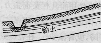
圖 1-2 帶有挖方的傾斜土層
