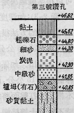
圖 2-2 鑽探結果的圖解說明
