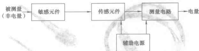
图 1—7 传感器的组成示意框图
