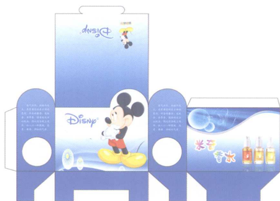
11.2.2 包装造型设计制作之包装盒展开平面图
