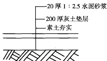
图 1-7 灰土垫层示意图
