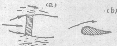
图1-2 泥沙顆粒受水流冲动时发生形状阻力的情况
