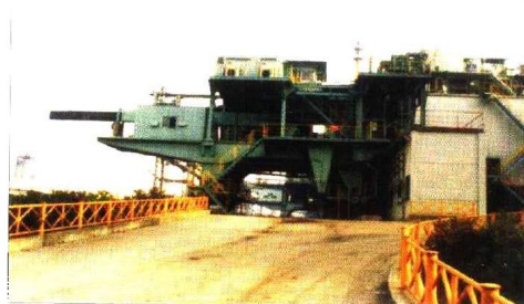
环保型6米焦炉推焦机
