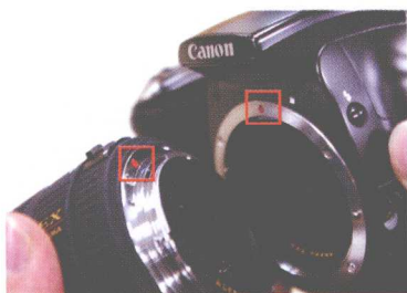
▲ 对准机身上的红点加装镜头（佳能）
