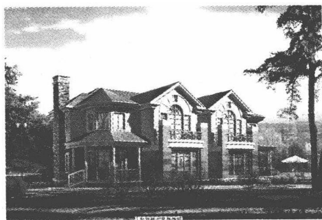
图 1-2 采用中心投影法所绘建筑图
