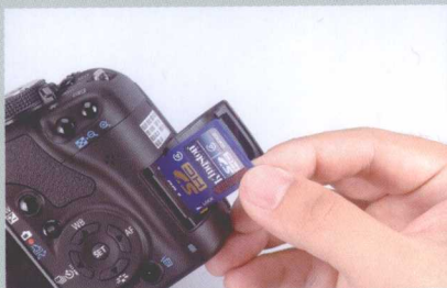
开启存储卡保护盖后，接着插入SD/SDHC存储卡
