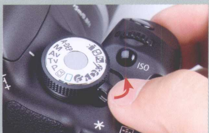
将拍摄转盘旁的电源按钮轻轻往上一扳即可开启相机电源
