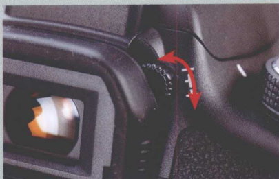
接着调整取景器旁的屈光度微调旋钮
