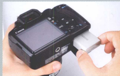
相机同样有保护装置，所以只要顺着同一方向即可安装使用
