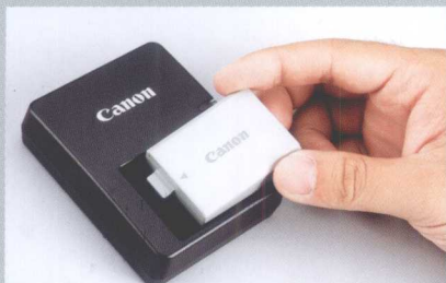
只要将电池对准充电器凹槽处插入即可进行充电
