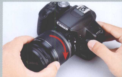
衔接后进行顺时针方向旋转，即可完成安装
