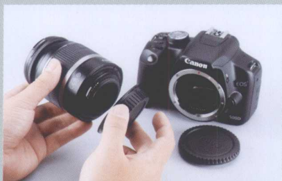
先将镜头后盖及机身前盖拆下
