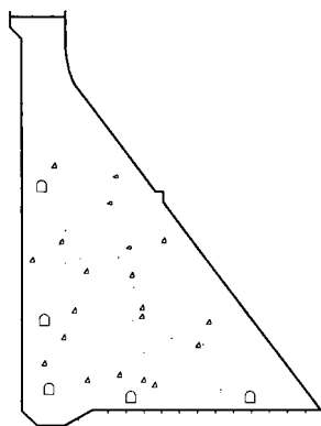
图 1.1-3 混凝土坝内廊道
