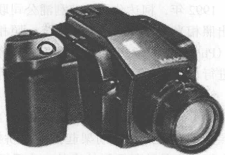
图1-1 索尼玛维卡(Mavica)——全球第一台不用感光胶片的电子相机
